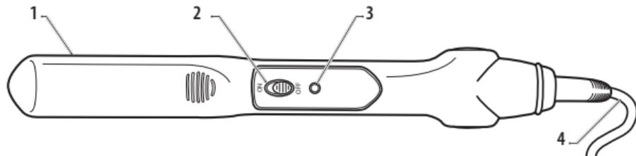
**1 Grelna plošča****2 Tipka za vklop/izklop****3 Svetlobna signalna lučka za prisotnost omrežja****4 Napajalni kabel****VKLOP**
